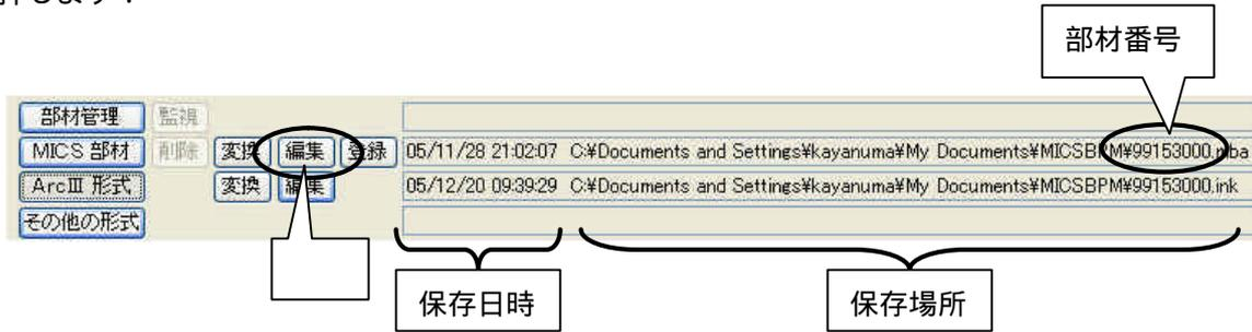
MICS/Arc にて新規部材を作成した場合は，MICS/Arc を終了すると，部品管理が表示されますので，【Arc 形式】をクリックして作成した部材を呼び出し，「MICS 部材」の【変換】後，上図の手順で部材情報編集を起動します．また，組合せ部材生成を行った場合も部品管理が起動されますので，上記の手順で部材情報編集を起動します．
