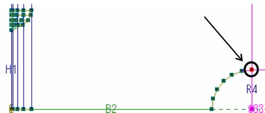
この頂点のY座標は、「B2+R4」になります。Y方向を確認すると、正しい数式が入っていませんので、Y方向をクリックし、「B2+R4」と入力して、【変数式の更新】ボタンを押します。
